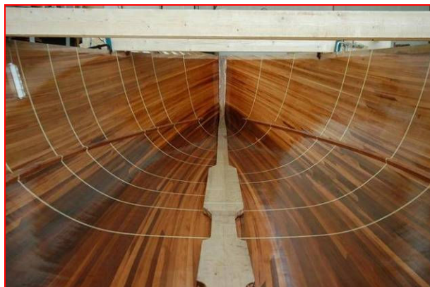
Particolare della costruzione dello scafo – Punti di applicazione dei sensori elastometrici
