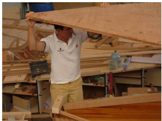
Foto 7: Lorenzo Luxich mentre verifica l'allineamento tra coperta e scafo.
