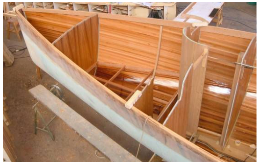
Foto 6: Dettaglio della prua in costruzione
