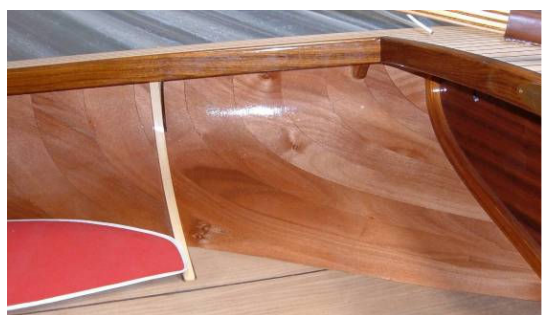
Foto 10: Risultato finale dell'applicazione delle singole dime di legno sul Feather 14', un cat boat progettato e realizzato dal Cantiere impiegando la stessa tecnologia costruttiva, che ha consentito di realizzare una barca di 14', abilitata per 4 persone, del peso di soli 125 kg completamente armata.
